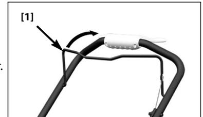
Continúe sosteniendo la palanca de las cuchillas completamente contra el manubrio. Esto mantendrá el motor y las cuchillas girando suavemente y evitará el desgaste prematuro del sistema de control de las cuchillas.
